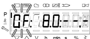
Если необходимо ввести угол открытия воздушной заслонки “0A” в точке розжига (например  $5^\circ$  - см. ниже) нажать “A” и одновременно “+” или “-”:
